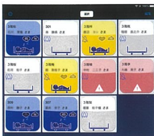
ベッドに設置したセンサーで入居者様の体動(呼吸や心拍など)を測定し、睡眠状態を記録する。
