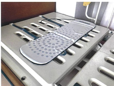
ベッドに設置したセンサーで入居者様の体動(呼吸や心拍など)を測定し、睡眠状態を記録する。
